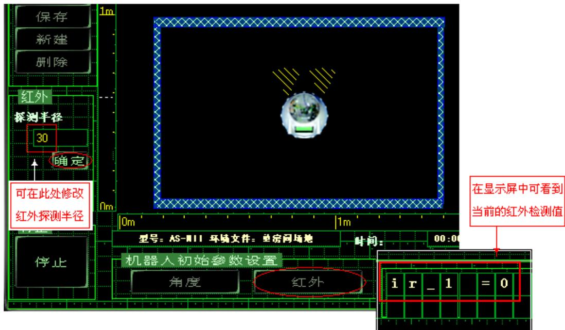
图 7.3 观察机器人前面没有障碍时的红外检测值
