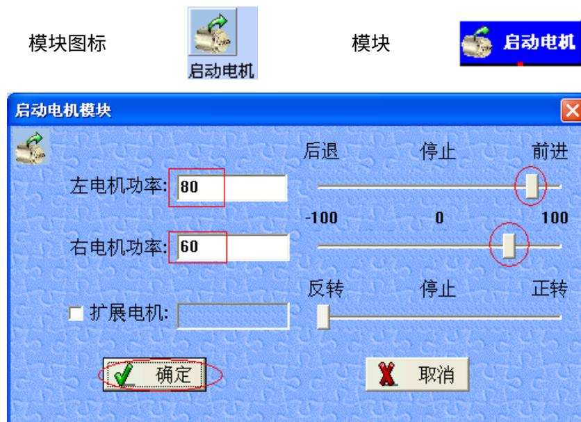
图 4.10 “启动电机”模块的设置
